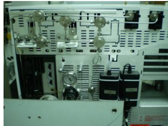
高潔淨度(BA)微洩漏的接頭及元件
