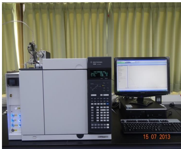
Agilent 氫氣氣體微量不純物分析儀
