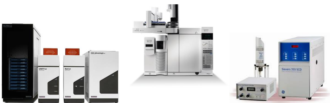
預濃縮設備/氣相層析質譜儀/硫化物化學螢光偵測器 TD-GC-MS/SCD
